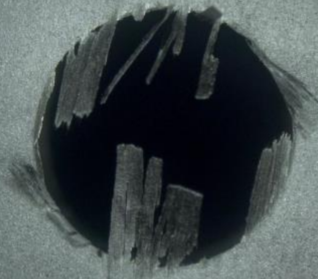
他社CFRP用ドリル 出口側
