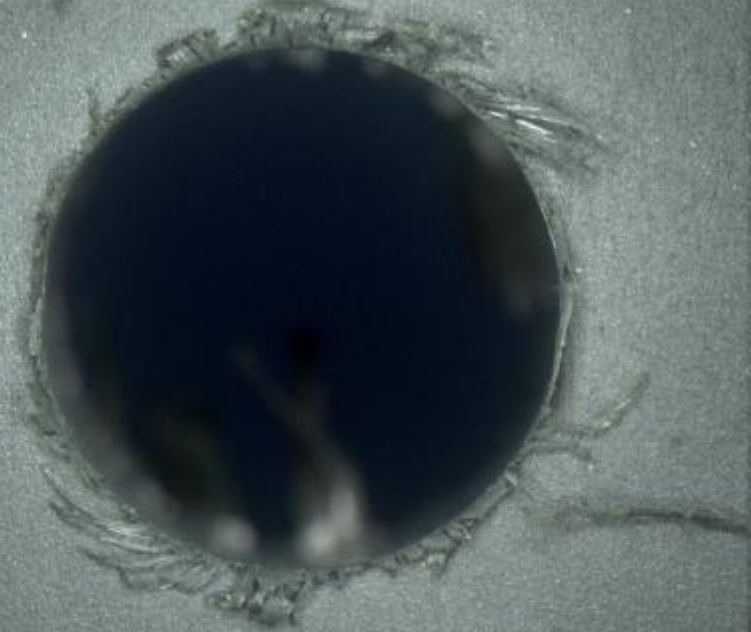
他社CFRP用ドリル 出口側
