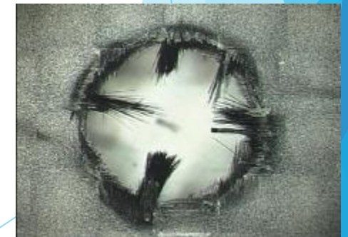
バリや 層間剥離が発生
